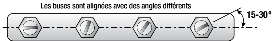
FIGURE 3 Angles d'alignement des buses
