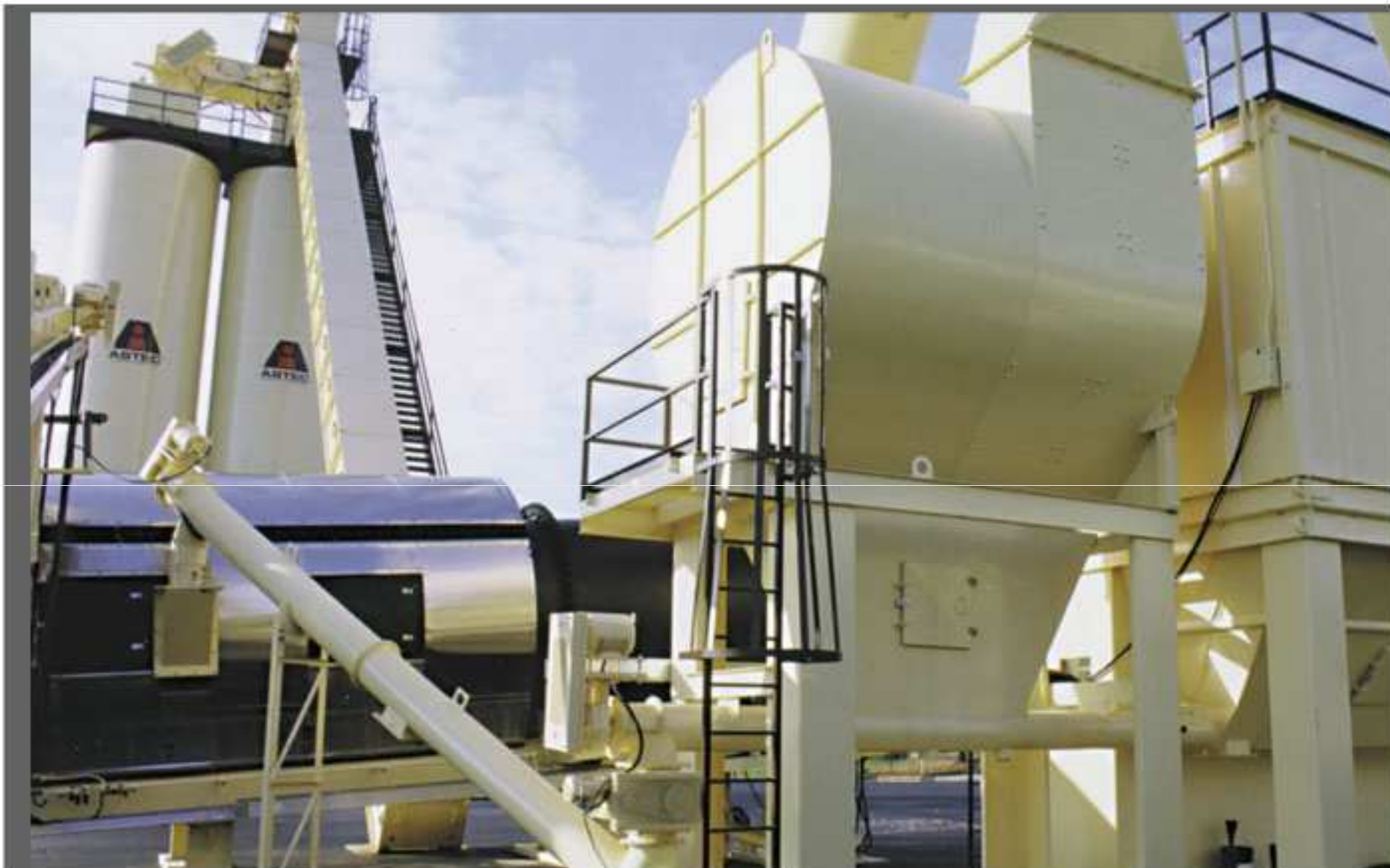
Dépoussiéreur avec cyclone horizontal
