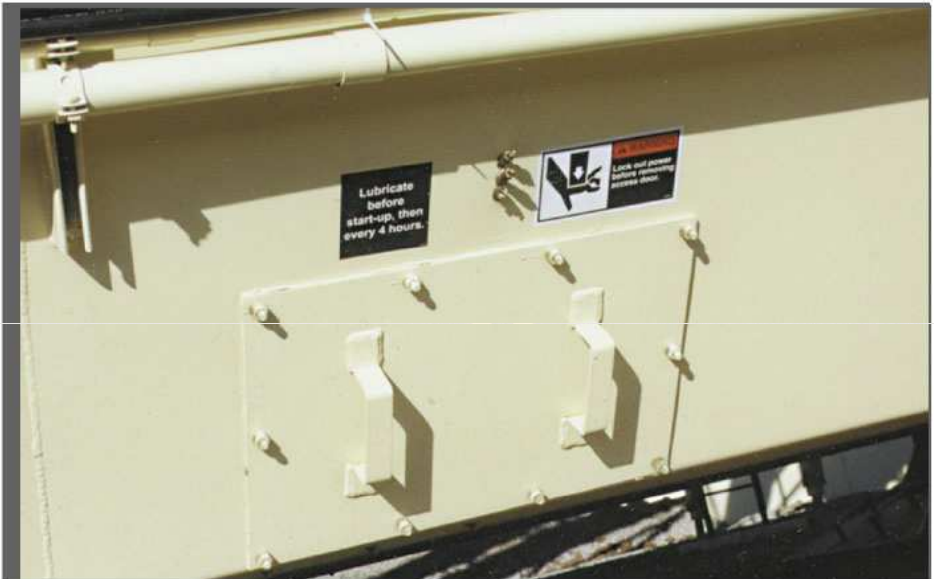
Porte étanche par graissage des accès à la vis sans fin
