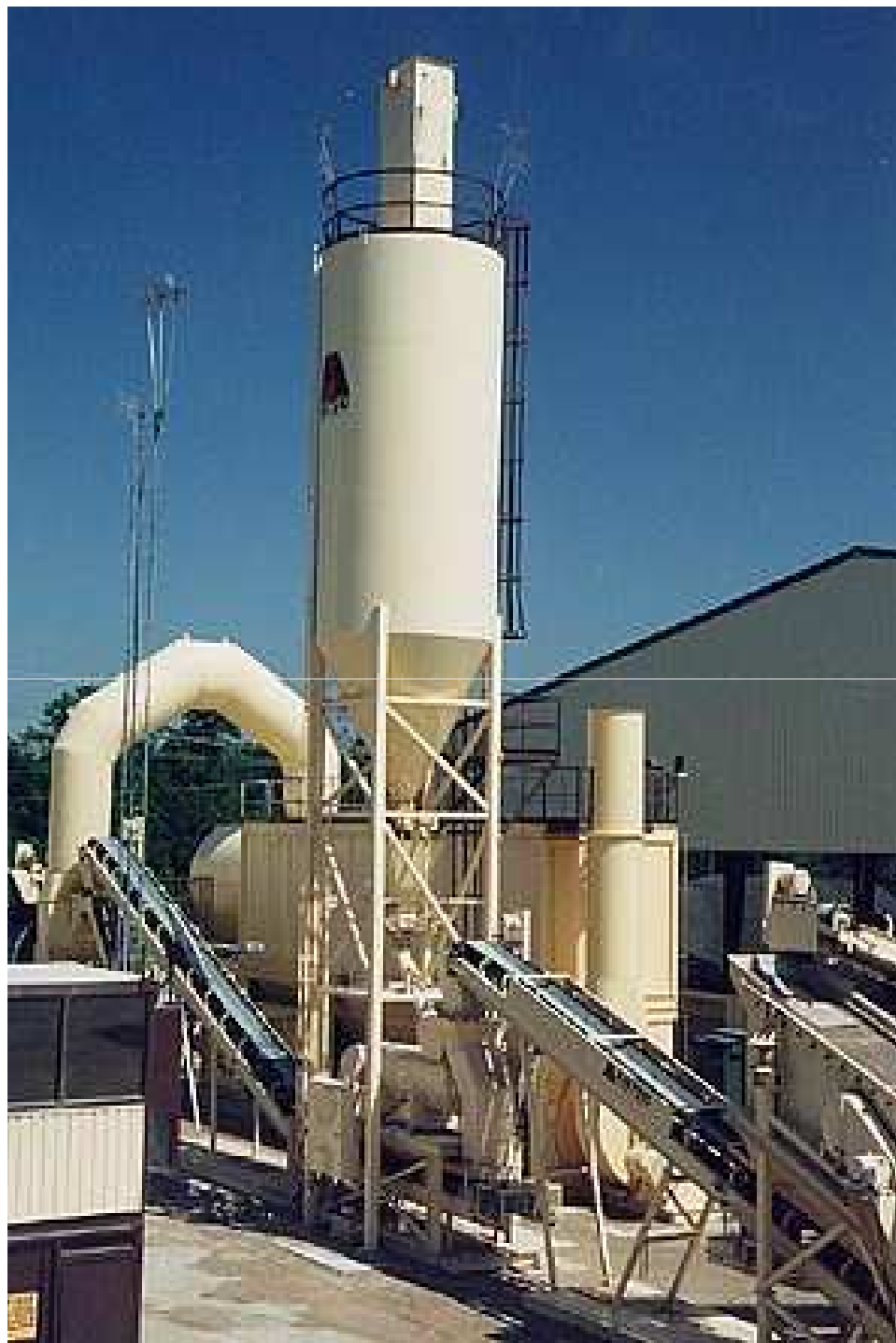
DOSAGE DU FILLER D'APPORT AVEC SILO SURELEVÉ
