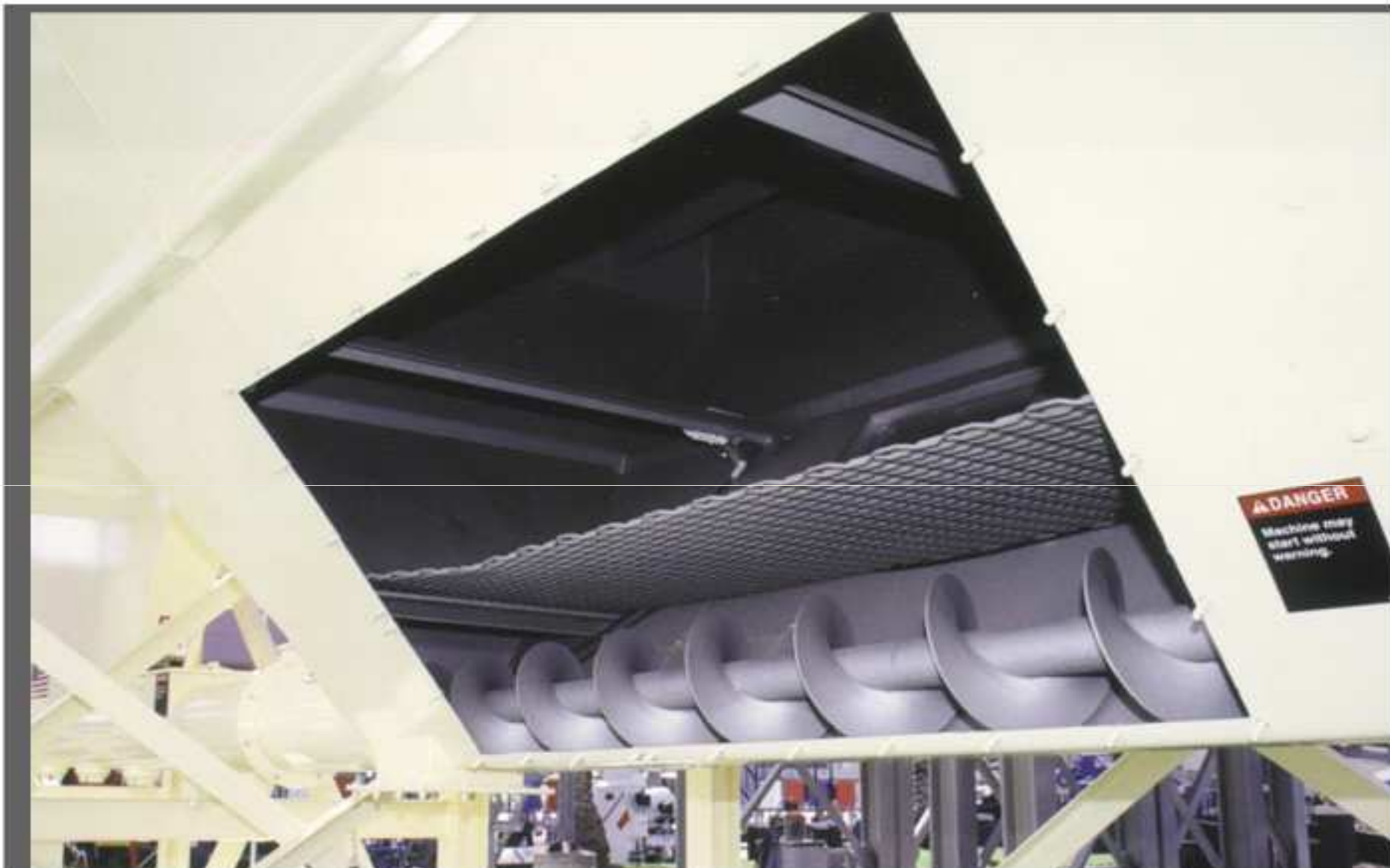
Vis sans fin en bas du dépoussiéreur
