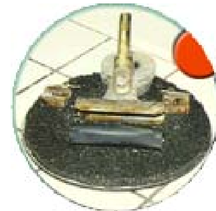
Résistance à l'abrasion Wet Track Abrasion Test
