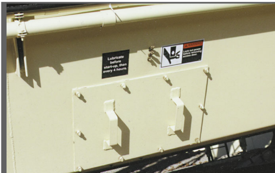
Porte étanche par graissage des accès à la vis sans fin
