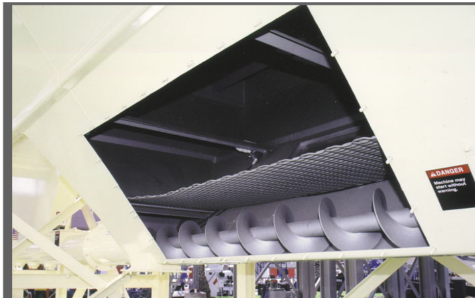
Vis sans fin en bas du dépoussiéreur
