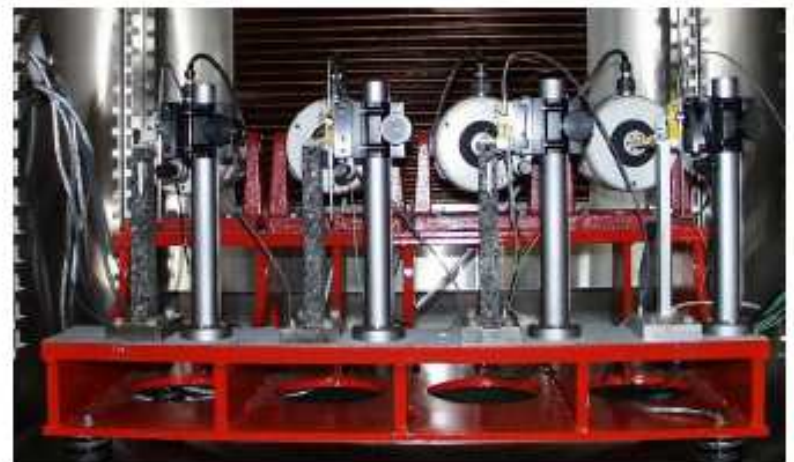
figure 19: Appareil de l'essai de flexion 2 points (LCPC-Nantes – France)
