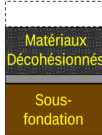
Enlèvement du matériel excédentaire et compaction
